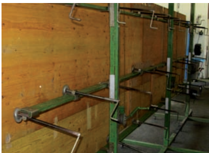
4. Detailansicht: Anpressvorrichtung vorbereiten
