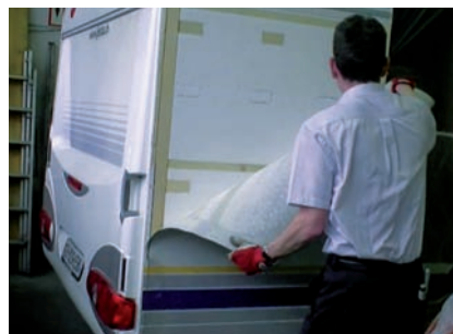
2. Abschälen des beschädigten Außenblechs
