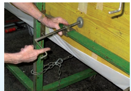
... und abschließendes Verpressen (ca. 3-6 Std bei +20 °C)
